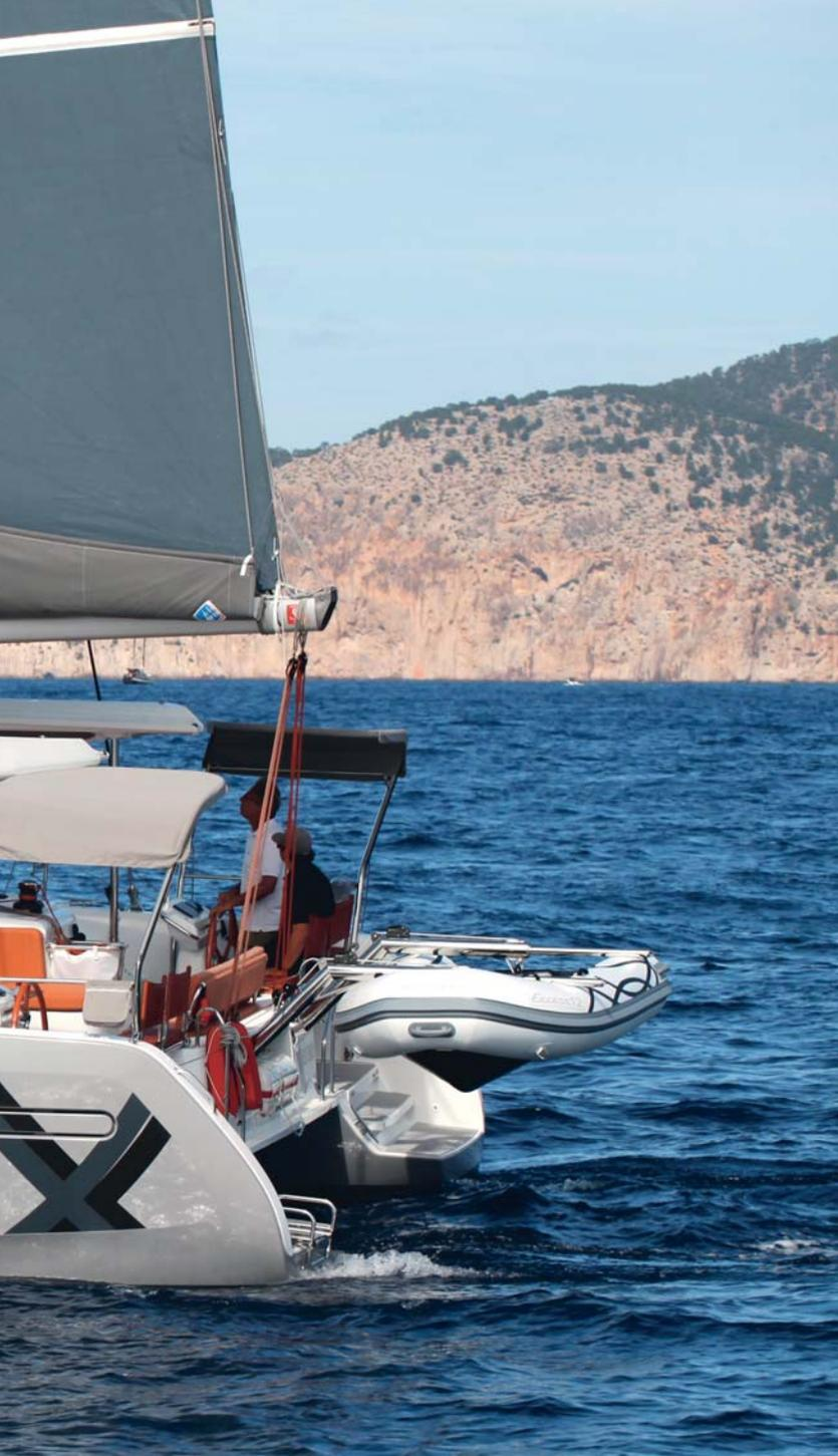
de voilure est à peine plus généreux (plus 70 centimètres carrés !) mais il est plus élancé, donc plus efficace. On peut gagner encore un peu de puissance et 5 mètres carrés de surface de toile avec la version «Pulse», qui est celle de notre voilier d'essai. La nacelle a été un peu raccourcie et l'utilisation du bois dans les aménagements, réduite pour gagner du poids, mais la différence avec un Lagoon n'est pas significative (environ 500 kilos de moins que le 40).
